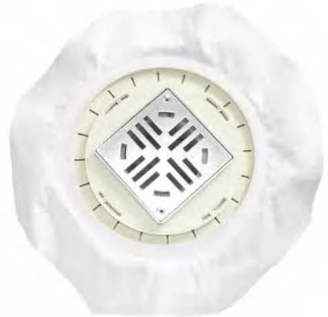
Aufstockelement mit verschiebbarem Rosteinsatz und flexibler werkseitiger Verbindung einer Dichtmanschette für die Einbindung in eine Flächenverbundabdichtung
